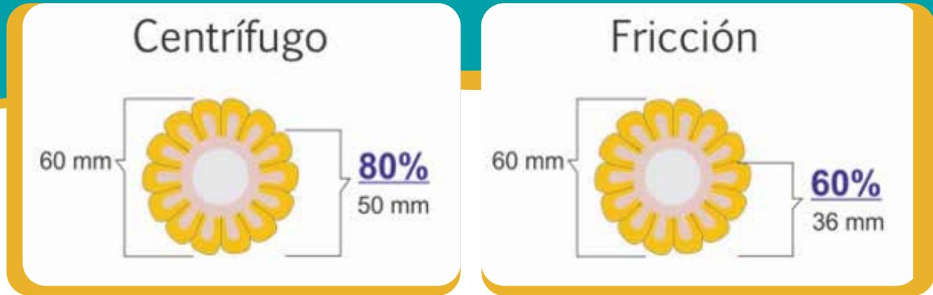
Apertura de camisa en función del diámetro de la espiga y del sistema axial.
