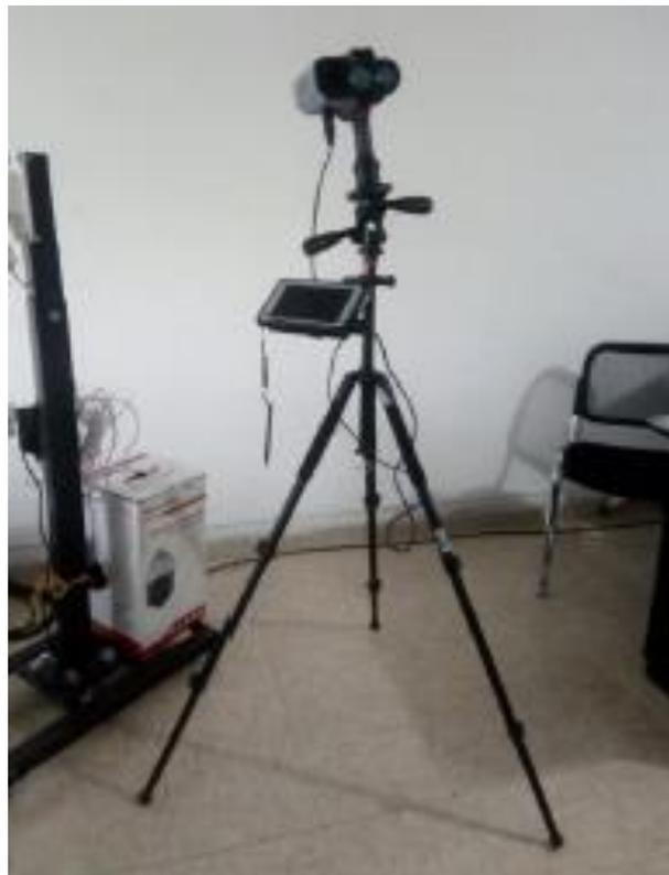
Figura 130. Radar DRAGONCAM.
