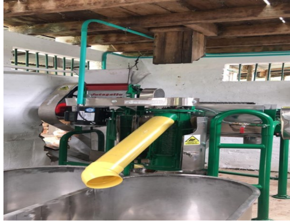
Actividad: lavadora y despulpadora de café
