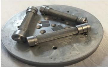
Figuras 1, 2. Biodispositivos cilíndricos recubiertos de titanio
